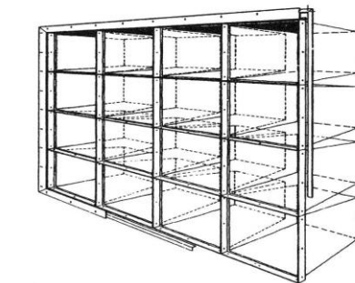
USPORIADANIE KAPSOVÝCH VLOŽKA S KAPSOVÝM FILTROM FILTROV V RÁMOVEJ KONŠTRUKCII
